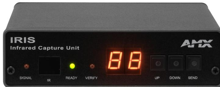
IRIS は民生用 AV 機器などの赤外線リモコンの赤外線データをキャプチャーする、IR/ シリアルデータキャプチャーデバイスです。IRIS でキャプチャーされた赤外線データは RS-232 で PC へ送信し、そのデータを基に対象機器のプログラミングを行います。
