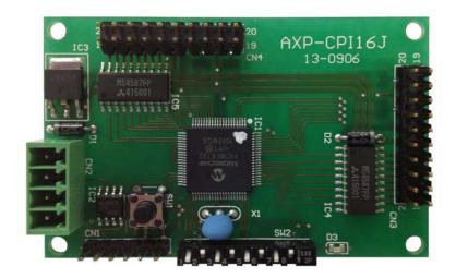
AXP-CPI16J は、特型スイッチパネルの接点、ランプを NXシステムコントローラー等と接続するための I/O基板です。 NXシステムコントローラーのAXLinkポートに接続します。
