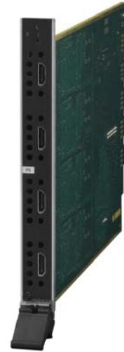
AMXのDGXスイッチャーシリーズより、4K UHDコンテンツに対応したHDMI入力ボードが新たにリリースされました。4つの入力ポートを備えており、HDMI、DisplayPort、DVI信号をサポートします。
