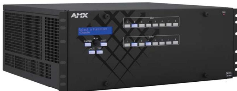
DGX800-ENC はマスター機能を搭載したモジュール式のデジタルマトリクススイッチャーです。4ch 毎に任意の信号種 (DVI / HDMI / DXLink / DXLink Fiber) のボードを実装することで、最大 8 入力 8 出力のマトリクスを実現します。
