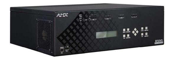
DVX-2210HD-SP は、NX-2200 相当のコントロールファンクション※に、4系統の映像入力(マルチフォーマット DVI 入力×2/HDCP 対応 HDMI 入力×2)にマトリクス出力が可能な2系統の HDMI 出力と1系統の DXLink 出力を搭載。音声部は2系統の HDMI エンベデッド、2系統のマイク入力に、アンプ出力とS/PDIF を含めた計3系統の音声出力を搭載し、プロフェッショナルなクオリティーの内蔵 DSP によるハイエンドな音場補正を実現します。加えて3Dや Deep Color、DTS-HDや Dolby TrueHD等の最新の A/V フォーマットにも対応。コントローラー、スイッチャー、アンプ、ミキサー...
