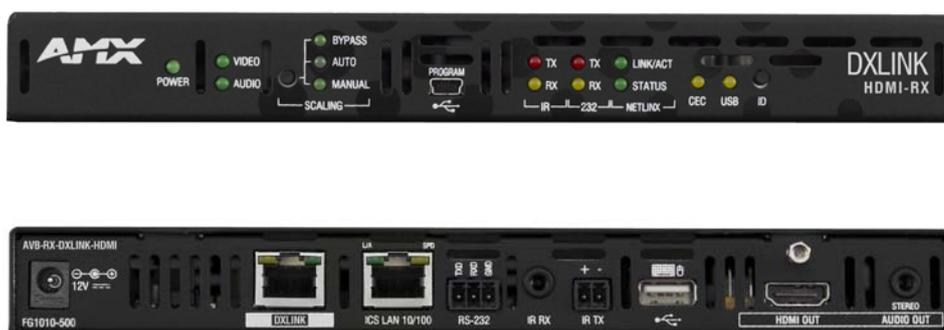
DX-RXは、DVXシリーズやDGXシリーズのDXLink出力ポートから伝送されたDXLinkを受信するレシーバーモジュールです。映像音声信号はHDMIとステレオアナログ音声にて出力されます。また、シリアルとIRポートを搭載し、出力先のデバイスコントロールも可能です。電源はEnovaDGX/DVXのDXLink入力ポート、PS-POE-AT-TC、PDXL-2よりツイストペアケーブルを利用供給されます。
