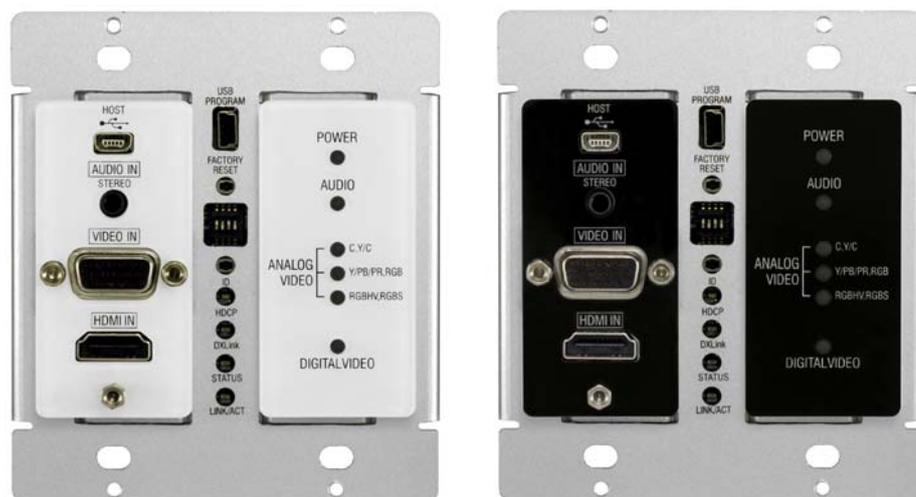
DX-TX-DWP は HDMI、またはアナログビデオ信号をツイストペアケーブルで最長100m 伝送できるデコラスタイルウォールプレートに装着可能な DXLink トランスミッターです。本機にて伝送されたメディアデータは EnovaDGX/DVX の DXLink 入力ポート及び DXLink レシーバー (DX-RX)で受信します。電源は EnovaDGX/DVX の DXLink 入力ポート、PS-POE-AT-TC、PDXL-2 よりツイストペアケーブルを利用し供給されます。
