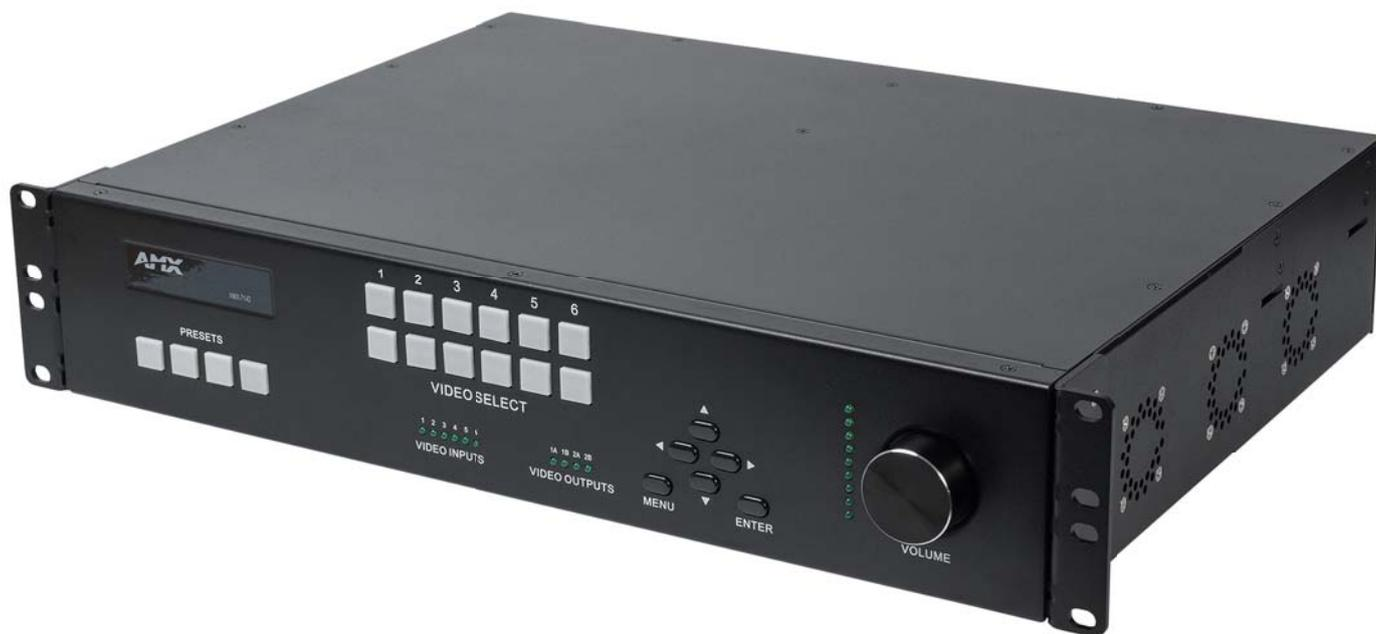
NMX-PRS-N7142 はローレイテンシーのネットワーク AV スwitchャーです。6 つのローカルインプット、4 つのアウトプット、そして SVSi のエンコーダー／デコーダーカード用の 4 つのカードスロットを有しています。4 つの HDMI 4K60 インプットと 2 つの VGA インプットのソースは 2 つの HDMI アウトプットにて、それぞれ個別にスイッチ可能です。
