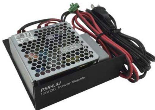
PSR4.3JはAMX 製品専用のパワーサプライです。12VDC 出力で 4.3A まで供給することが可能です。AVB-RMK ラックマウントトレイキットにマウントできる 1/4 サイズのコンパクト設計です。AMX の NX シリーズコントローラー、Modero シリーズタッチパネル (MXT/D-2001) のパワーサプライとして使用します。
